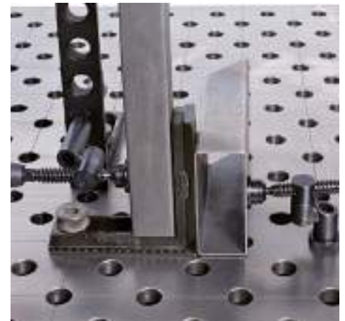
Két teljes értékű derékszög felület – így mindkét oldala használható
